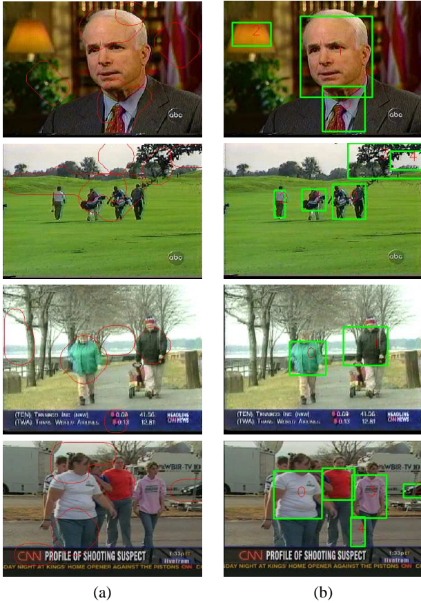
Şekil 2: Görsel örneklerle iki yöntemin karşılaştırılması (bulunan ilk 5 bölge). (a) SM yöntemi, (b) Bu çalışmada önerilen yöntem (her bölge içindeki sayı o bölgenin bulunma sırasını göstermektedir).
